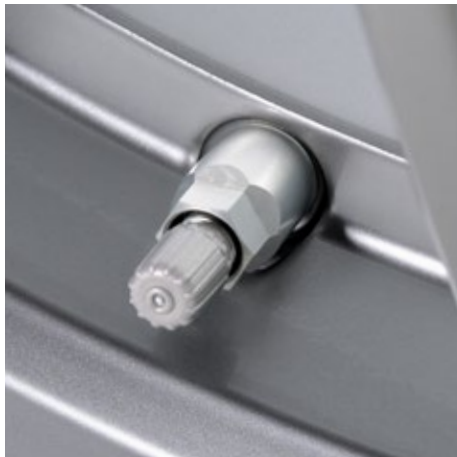
PLATIN Sens - silber RDKS-Sensor mit silbernem Metallventil
